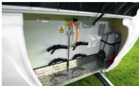
↑ De disselkast van de c'joy heeft een mooie traanplaat bodem
