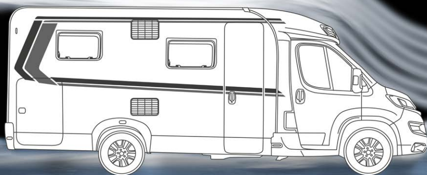
Typisch Van-klasse: gestroomlijnde aerodynamica, geringe luchtweerstand en lage CW-waarde.
