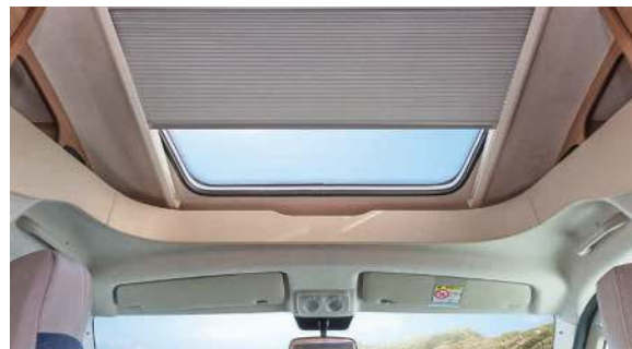
Sunblind on the skylight. / Oprolbare zonwering in het dakraam. / Solrullegardin på tagvinduet.
